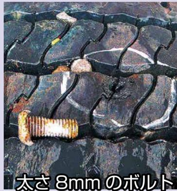
今後の対策 太さ8mmまでの突き刺しパンクに効果があるコンバット12を注入
