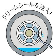
空気を抜き空気充填口から規定量注入します。
